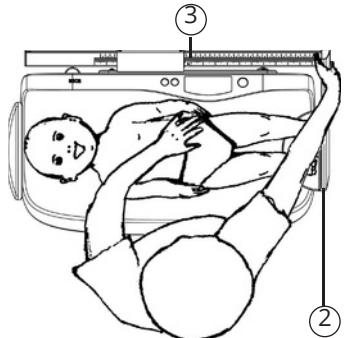
2. Com a mão direita, empurre o apoio para os pés (2) na direcção dos pés do lactente, de modo a que os pés do lactente fiquem sobre o apoio. Com a mão esquerda, segure o lactente sobre o tabuleiro da balança.
