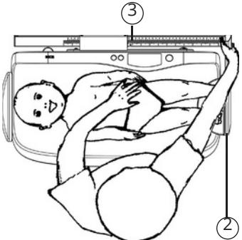
2. Χρησιμοποιήστε το δεξί σας χέρι για να σύρετε το στήριγμα ποδιών (2) προς τη φορά των ποδιών του βρέφους, ενώ τοποθετείτε τα πόδια του βρέφους πάνω στο στήριγμα ποδιών. Με το αριστερό σας χέρι σταθερο-ποιήστε το βρέφος πάνω στη λεκάνη της ζυγαριάς με βρέφοντα.
