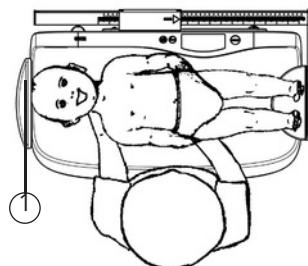
1. Den Säugling auf die Waagenmulde legen. Der Kopf des Säuglings muss am Kopfanschlag (1) der Mulde liegen.
