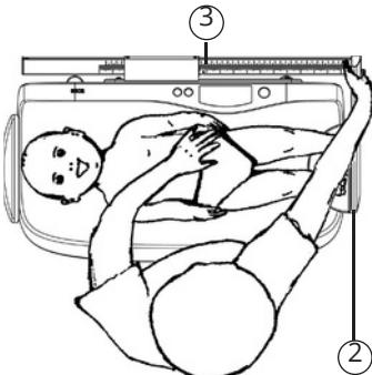
2. Mit der rechten Hand die Fußstütze (2) in Richtung der Füße des Säuglings schieben, dabei die Füße des Säuglings auf der Fußstütze ablegen. Mit der linken Hand den Säugling auf der Waagenmulde fixieren.
