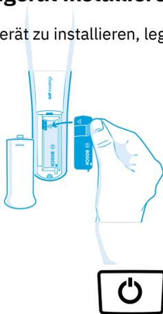
1. Öffnen Sie das Akkufach auf der Rückseite des *Vivatmo pro*-Handgeräts.
