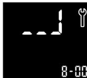
1. Das **Schraubenschlüssel**-Symbol auf dem Handgerät zeigt an, dass der Rekonditionierungsvorgang läuft. Die verbleibende Rekonditionierungsdauer wird in Minuten angezeigt.
