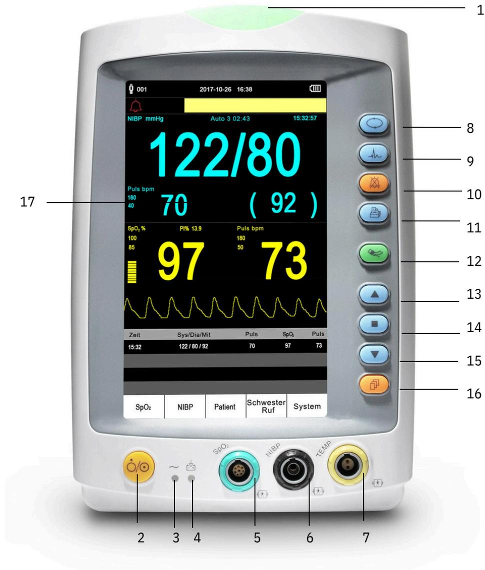
Abbildung 3.1A Vorderseite des Monitors (ohne EKG-Funktion)
