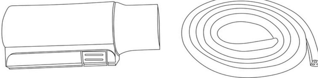
Schaubild 1: Kompletter Messkopf + Verbindungsschlauch
