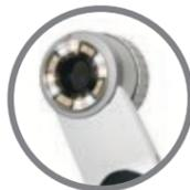
Kreuzpolarisiertes und unpolarisiertes Licht auf Knopfdruck
