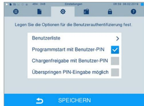
4. Setzen Sie bei der Option **Chargenfreigabe mit Benutzer-PIN** einen Haken, um bei jedem Programmende eine Benutzerauthentifizierung durchzuführen. Die Gerätetür öffnet nach Programmende erst nach Eingabe der Benutzer-PIN.
