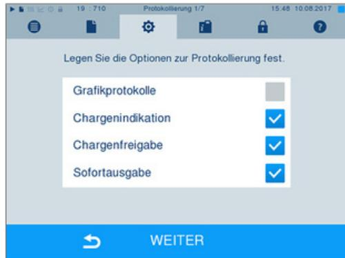
**Chargenindikation** umfasst die Überprüfung der im Sterilisierprogramm mitgeführten Indikatoren, z. B. MELAcontrol Helix oder MELAcontrol Pro. Nur bei einem vollständigen Farbumschlag der Indikatorstreifen kann die Freigabe der Indikatoren erfolgen.
