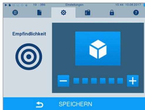
2. Wählen Sie durch Drücken der Schaltflächen **-** oder **+**, wie stark der Druck beim Berühren einer Schaltfläche ausgeübt werden muss, damit ein Ereignis ausgelöst wird.
