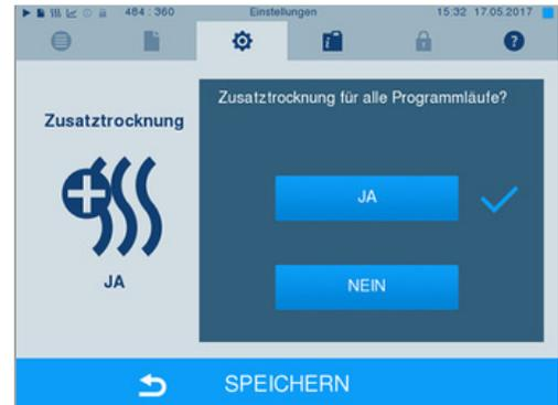
2. Wählen Sie durch Drücken der Schaltfläche JA oder NEIN, ob für alle folgenden Programmläufe eine Zusatztrocknung erfolgen soll.
