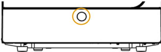
Abb. 4: Serviceklappe öffnen/schließen
