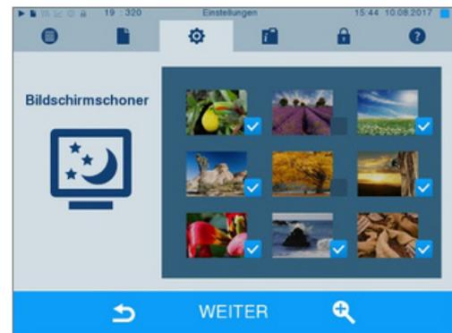
2. Um ein Bild auszuwählen, tippen Sie auf das entsprechende Bild. Der weiße Rahmen um das Bild zeigt, welches Bild gerade ausgewählt ist.
