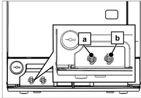
4. Öffnen sie den Entleerungshahn, indem Sie den Knauf um eine 1/4 Umdrehung gegen den Uhrzeigersinn drehen.
