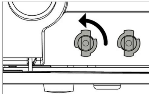
5. Um den Entleerungsschlauch wieder zu entfernen, drehen Sie den Schlauchanschluss wieder in die senkrechte Stellung.
