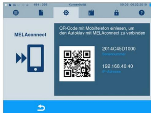
Ê Bei manueller Eingabe der IP-Adresse: Besitzen Sie mehrere Autoklaven des selben Gerätetyps, können Sie anhand der angezeigten Seriennummer kontrollieren, ob sich MELAconnect mit dem richtigen Gerät verbunden hat.
