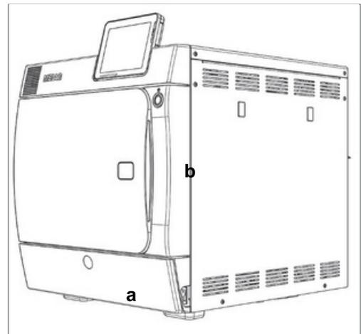
3. Stecken Sie den im Lieferumfang enthaltenen Innensechskantschlüssel (5 mm) in die Öffnung. Der Innensechskantschlüssel kann in der speziell dafür vorgesehenen Halterung hinter der Serviceklappe aufbewahrt werden.
