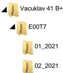
Der Autoklav prüft also bei jeder Art der Protokollausgabe (Sofortausgabe nach gelaufenem Zyklus oder Übertragung mehrerer Protokolle auf einmal) das Speichermedium und legt automatisch bei Nichtvorhandensein ein Verzeichnis des Gerätes und des Monats an. Werden Protokolle mehrfach auf ein- und dasselbe Speichermedium ausgegeben, wird dort unter dem Geräteverzeichnis ein Verzeichnis mit der Benennung „Doppelt“ angelegt.
