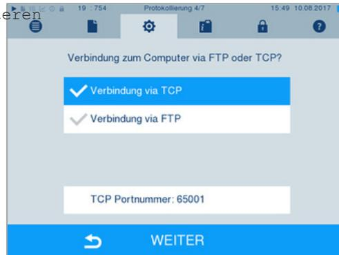
2. Drücken Sie auf die untere Schaltfläche, um den voreingestellten TCP-Port zu ändern. Das Display wechselt in das Einstellungsfenster.
