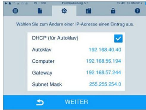
2. Prüfen Sie, ob die am Autoklav eingestellte IP-Adresse des Computers korrekt ist.
