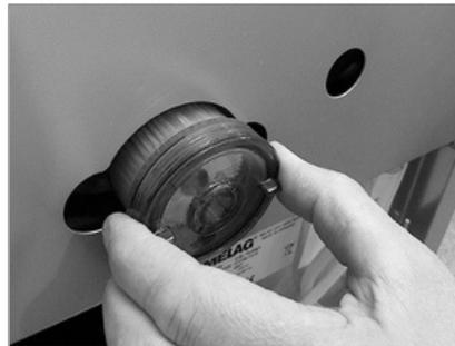
2. Ersetzen Sie den Sterilfilter durch einen neuen **oder** sterilisieren Sie den aktuellen Sterilfilter, siehe [Sterilfilter sterilisieren](#) [ ] Seite 45].
