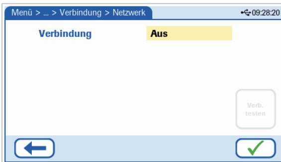
4 Um eine Netzwerkverbindung zu deaktivieren oder zu aktivieren, den erforderlichen Typ der **Verbindung** einstellen. Zum Speichern auf die Schaltfläche **✓** tippen.
