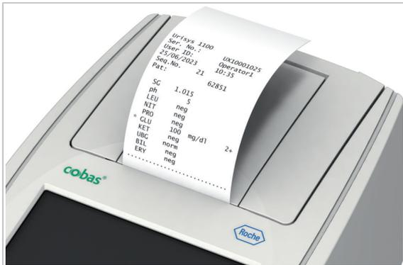
Je nach Konfiguration Ihres Geräts wird der Patientenbericht automatisch nach jeder Messung ausgedruckt. Alternativ können Sie ihn auch ausdrucken, indem Sie auf die Schaltfläche
