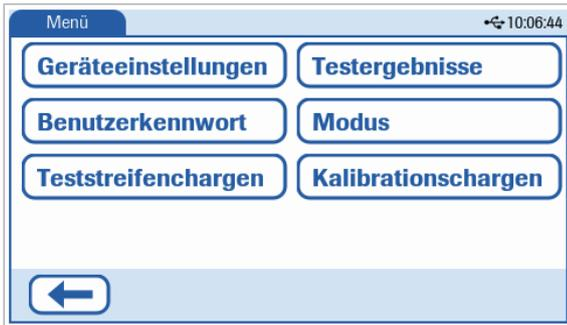
2 Um eine neue Streifencharge einzugeben, im Bildschirm **Teststreifenchargen** auf die Schaltfläche tippen.
