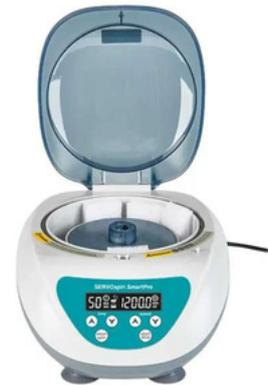
Kompakte Mikro-Hämatokrit Zentrifuge mit Wechselrotoren für Micro Gefäße.
