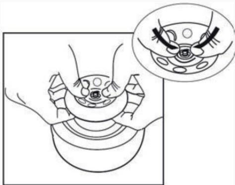
Wie auf der bildlichen Darstellung, mit beiden Daumen die Verriegelung des Rotors nach unten drücken und den Rotor langsam nach oben ziehen.
