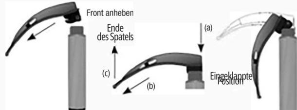
Hinweis: Ein falscher Einbau des Spatels kann zu Schäden an dem Spatel oder zu Fehlfunktionen des Geräts führen.
