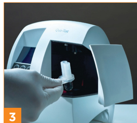
3 Kartusche im Analyzer platzieren. Anzeige des Messwertes innerhalb von 4 min.
