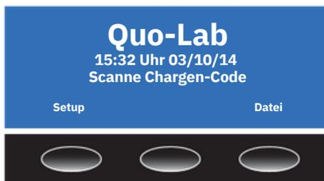
Sobald der Analyser aufgewärmt ist, erscheint das Quo-Lab Logo auf dem Display. Dies ist der Startbildschirm. Der Tastenbereich unter dem blauen Bildschirm umfasst drei Tasten. Der Text auf dem Display direkt oberhalb der einzelnen Tasten zeigt deren Funktion an. Wird kein Text über der Taste angezeigt, hat diese Taste keine Funktion. Die Funktionen der Tasten ändern sich je nach Bildschirm.
