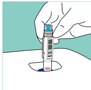
**5** Wählen Sie "Messen" auf dem Display des QuikRead go Instruments. Setzen Sie die Küvette mit dem Barcode nach vorne gerichtet in das Küvettenfach ein.
