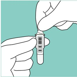
**1** Entfernen Sie die Aluminiumfolie von der Küvette. Achtung: die Küvette nur in der oberen Hälfte berühren.
