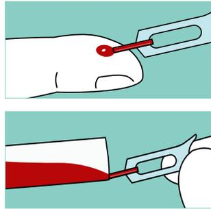
**2** Halten Sie den QuikRead go Sample Collector 10µl fast horizontal und entnehmen Sie die Blutprobe, indem Sie Spitze des Probennehmers knapp unterhalb der Oberfläche des Blutstropfens halten. Füllen Sie die Kapillare vollständig auf.
