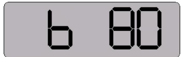
Bild 3-6 Batteriekapazität liegt bei 80 %
