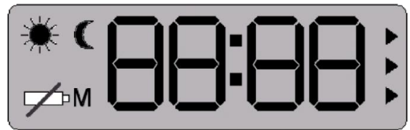
Bild 3-5 Testbild der LC-Anzeige
