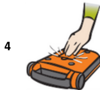
4 Herunterdrücken, bis Klickgeräusch zu hören ist
