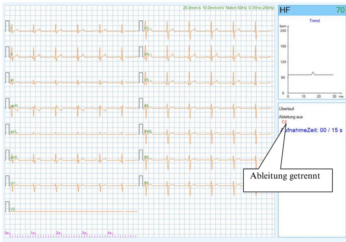
Abb. 2.14 Anzeige bei Trennung des Leiters
