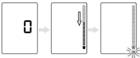
3. Prüfen Sie die „0“-Anzeige und führen Sie die Druckgenauigkeitsprüfung durch. Legen Sie den externen Druck an. Vergleichen Sie mit dem angezeigten Wert und stellen Sie sicher, dass kein Problem vorliegt.
