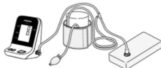
2. Überprüfen Sie den Druckwert des Blutdruckmessgerätes und den Druckwert des kalibrierten Referenzmanometers.
