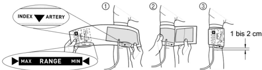
Stellen Sie sicher, dass INDEX ARTERY „▼“ innerhalb des Bereichs ► MAX RANGE MIN ◀ liegt. Wenn außerhalb des Bereichs ► MAX RANGE MIN ◀, kommt es zu größeren Fehlern beim Blutdruckwert. Verwenden Sie in diesem Fall eine geeignete Manschengröße.
