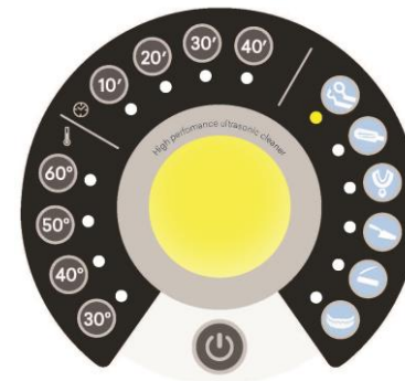
Gelbes blinkendes Licht. Die Temperatur der Flüssigkeit im Behälter ist zu hoch für den gewählten Zyklus. Die Kühlung abwarten.
