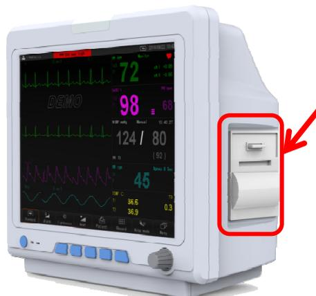
Fig. 12-1 Druckerposition
