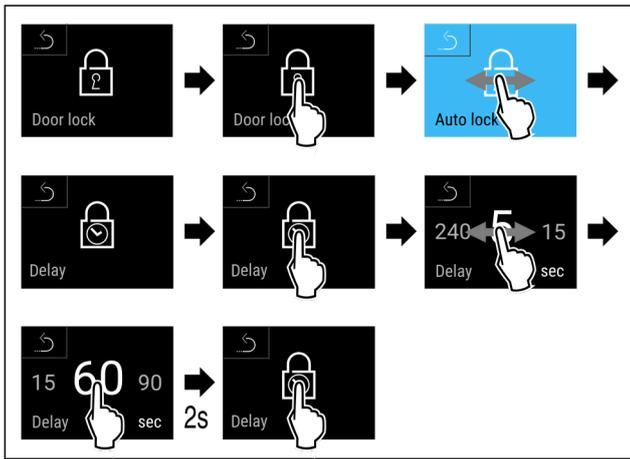
Fig. 82 Folgende Werte sind einstellbar: 5, 15, 60, 90, 120, 180 und 240 Sekunden
