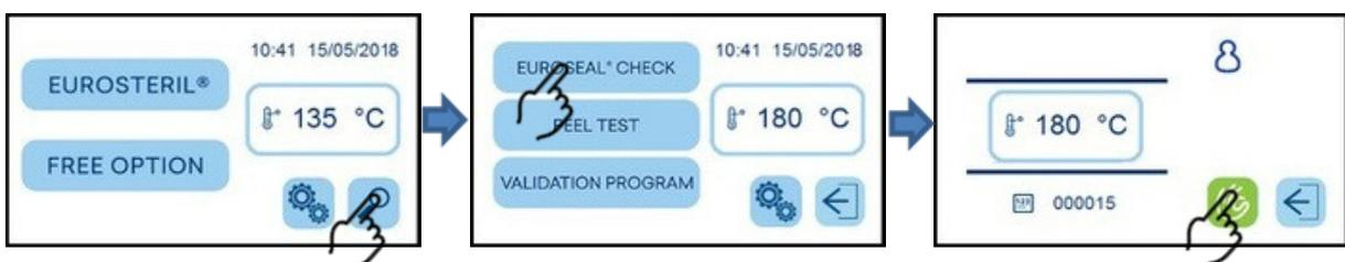
Nach Bestätigen des Programms (gleich, ob es sich um ein Standardschweißprogramm oder um einen Test handelt), heizt das Gerät auf die eingestellte Schweißtemperatur auf. Der Fortschritt der Temperatur wird durch eine progressive rote Leiste angezeigt. Bei Erreichen derselben kann mit dem Schweißen begonnen werden:
