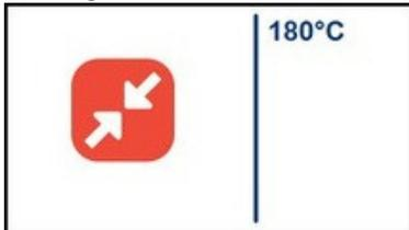
**Temperaturproblem:** Es wird versucht zu schweißen, aber das Gerät hat noch nicht die erforderliche Schweißtemperatur erreicht.
