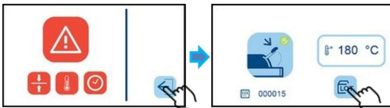
Nach Ende der Schweißung muss die Partie geschlossen werden, indem man auf die Ikone klickt.
