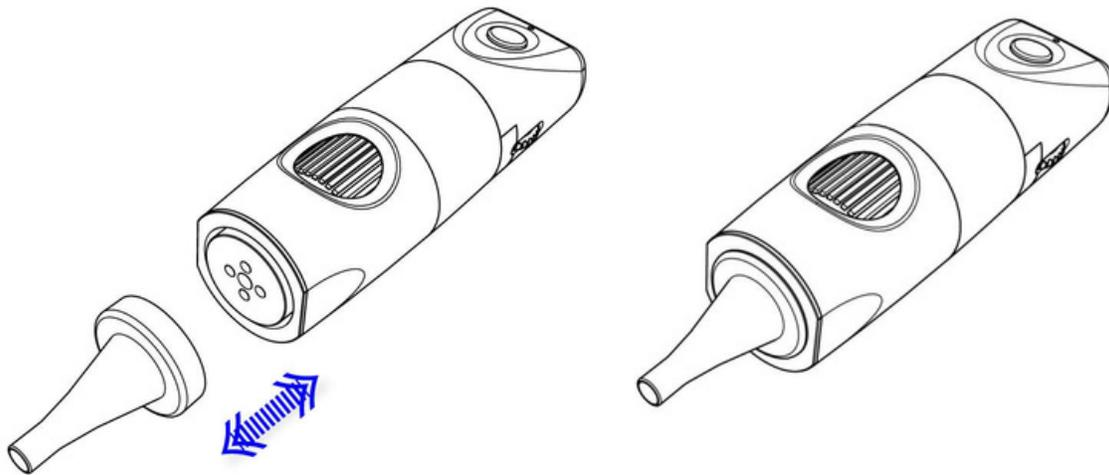
Stecken Sie die Specula in die runde, konkave Form an der Vorderseite. Zum entfernen: Ziehen Sie einfach die Spectula heraus.
