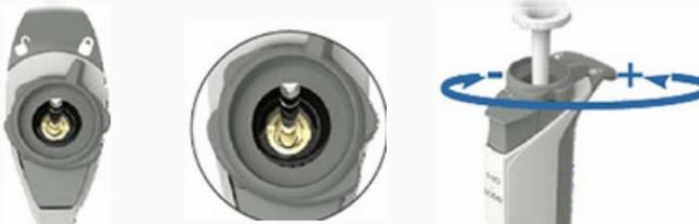
5. Drehen Sie das Kalibrierwerkzeug gegen den Uhrzeigersinn um das Volumen zu vergrößern und gegen den Uhrzeigersinn um es zu verkleinern.
