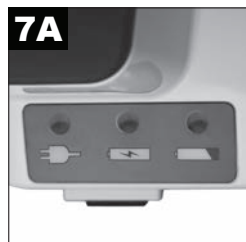
7A 7314P - Vælg den ønskede strømkilde. (Spring trin 6B over ved brug af det indvendige batteri.)
