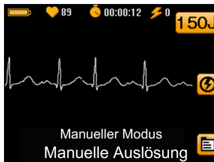
Manueller Modus: Elektroden angebracht
