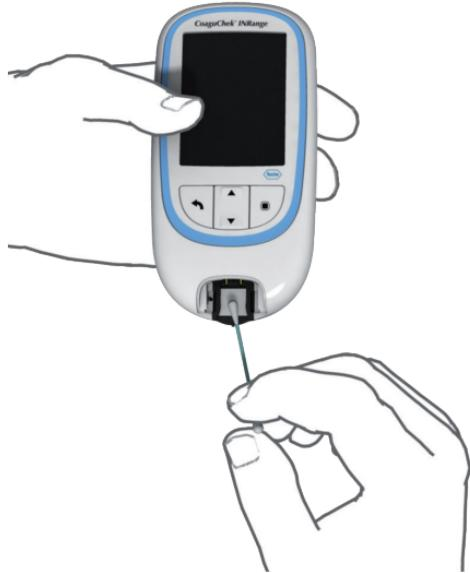
3 Halten Sie das Gerät senkrecht, wobei die Teststreifenführung nach unten zeigt.
