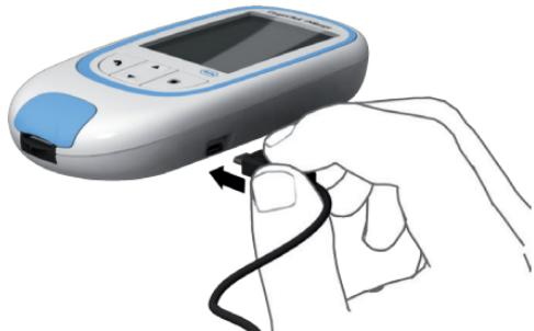
Um das Gerät mit einem Computer zu verbinden, benötigen Sie ein geeignetes USB-Kabel (im Lieferumfang enthalten). Verbinden Sie den USB-Stecker (Typ B) mit dem Gerät und den USB-Stecker (Typ A) mit dem Computer. Der USB-Port befindet sich an der rechten Seite des Gehäuses. Sie müssen für die Datenübertragung das Kabel immer zuerst mit dem Gerät und erst dann mit dem Computer verbinden.
