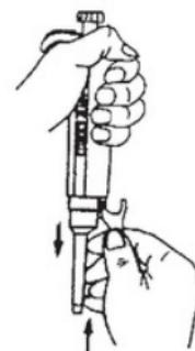
3). Lassen Sie den Pipettenspitzenabwurf los und nehmen Sie den Abwurfhals ab
