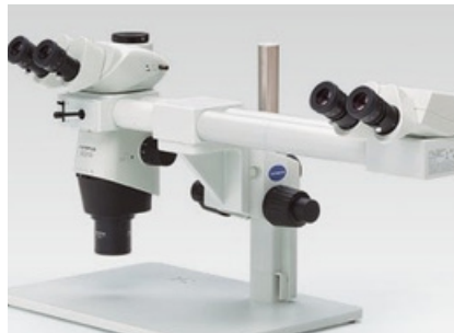
Ausziehbarer Zwischentubus zur Anpassung der Einblickhöhe (SZX2-EEPA)(SZX-SDO2)
