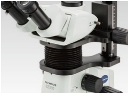
Ausziehbarer Zwischentubus zur Anpassung der Einblickhöhe (SZX2-EEPA)(SZX-SDO2)
